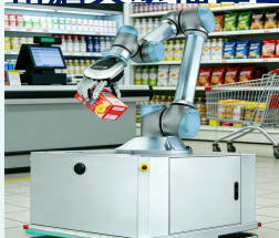
集成底盘与机械臂协同运动系统、智能调度模块及多模态传感器
