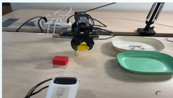
采用两个ViperX 6-DoF机器人手臂和3D打印组件，采用关节空间映射
