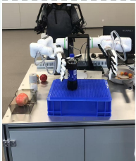
集成协同机械臂、实操工作台、五指灵巧手
